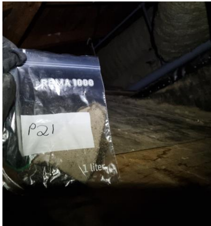
Figur 20 Prøve (P21) tatt av takpapp i Blokk 1, det ble ikke påvist asbest i prøven.
