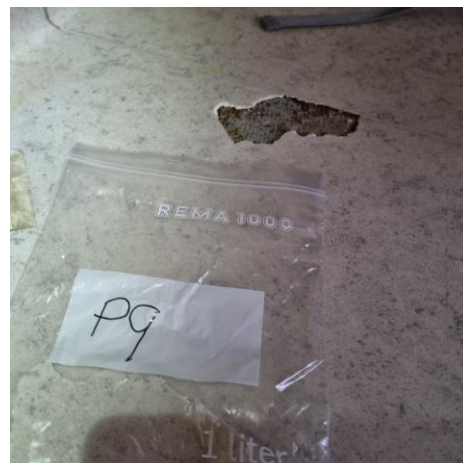
Figur 28 Prøve P9, hvitt gulvbelegg m/ lim, i rom 229 plan 2 Blokk 2. Det ble ikke påvist asbest i prøven.
