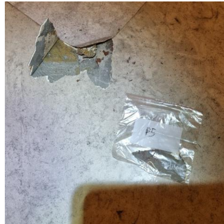
Figur 24 Prøve P5, gulvbelegg m/ gult lim, i rom 132 plan 1 Blokk 1. Det ble ikke påvist asbest i prøven
