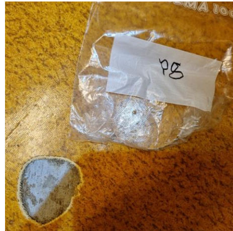
Figur 27 Prøve P9, oransje linoleum m/ lim, i rom 215A plan 2 Blokk 2. Det ble ikke påvist asbest i prøven.
