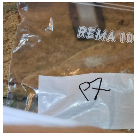
Figur 26 Prøve P7, grått gulvbelegg m/ lim, i korridor underetasje Blokk 1. Det ble ikke påvist asbest i prøven.
