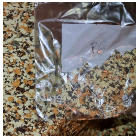
Figur 25 Prøve P6, epoksy (terrazzo utseende), i trappesjakt Blokk 1. Det ble ikke påvist asbest i prøven
