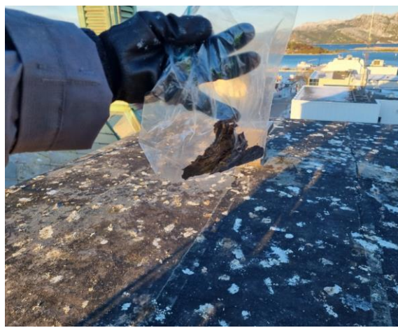
Figur 19 Taket av Blokk 1 teknet med takpapp (P1), det ble ikke påvist asbest i prøven.
