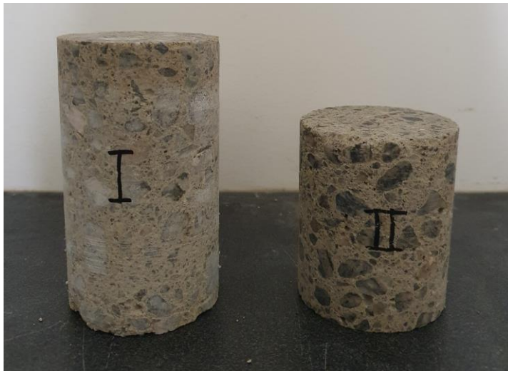
Figur 52 Prøve (P30 og P31) fra kjerneboring i etasjekiller i Blokk 1.
