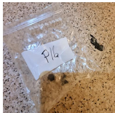
Figur 32 Prøve P16, lys rosa m/ svart lim, i rom 354 plan 3 Blokk 1. Det ble ikke påvist asbest i prøven.
