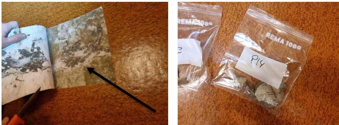
Figur 57 Prøve (P14) av avretting på gulv. Det ble ikke påvist PCB eller asbest i prøve.
