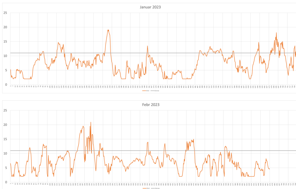
Figur 4-8: Illustrasjon av korleis vindstyrken varierer (m/s) i modellpunktet NORA 3 gjennom heile 2023. (Eit diagram pr måned.) Dei tynne strekane i diagrammet indikerer ei inndeling i dagar pr måned.
